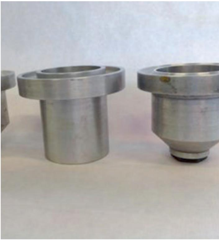
**20 - Le coppe Ford utilizzate per la misurazione della viscosità della soluzione**
