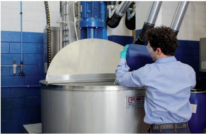
**4 e 5 - L'operatore produce una soluzione attraverso uno dei due miscelatori da 7.5 kW del nuovo impianto produttivo**
