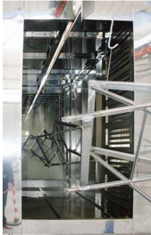
9 – L'ingresso dei pezzi nel tunnel di pretrattamento monostadio, che comprende lo sgrassaggio e la passivazione della superficie.
