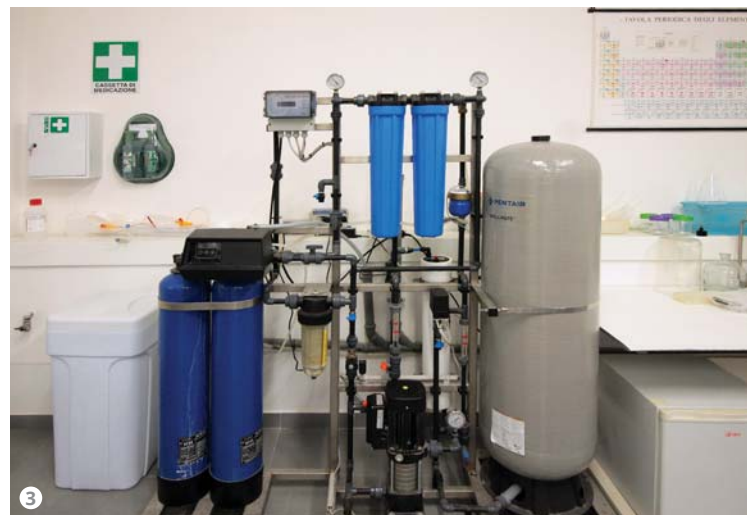
Figura 3: L'impianto ad osmosi inversa da 200 litri/ora con filtri UV a marchio Chemtec è stato recentemente presentato al mercato.
