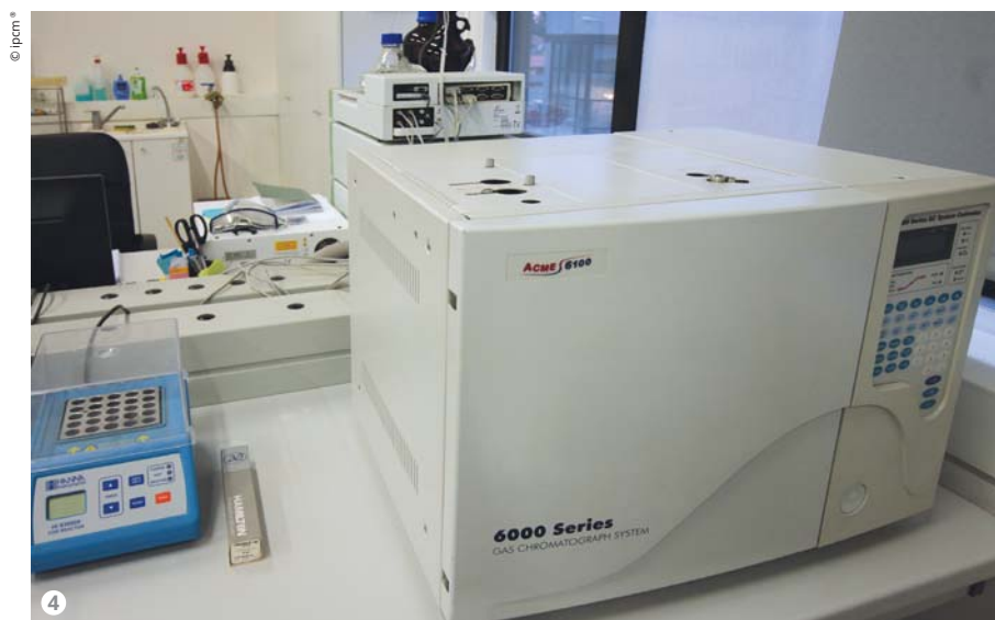
Figura 4: Il gas cromatografo per il controllo delle materie prime.
