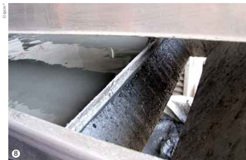
Figura 8: La racla raccoglie le molecole inerti e le spinge nel contenitore dei fanghi.
