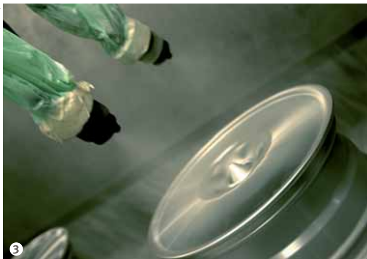
Figura 3: Applicazione della vernice liquida con robot antropomorfo.
