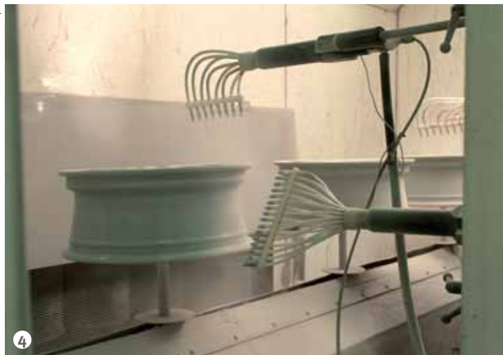
Figura 4: Applicazione del trasparente in polvere.
